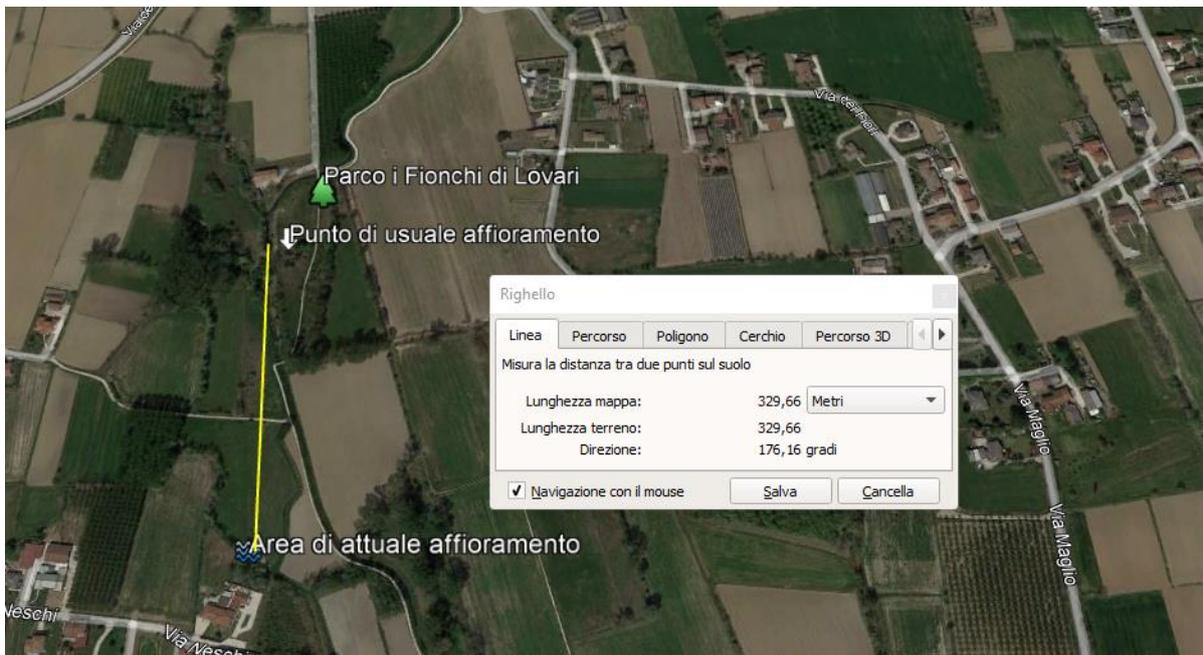
Figura 8: Esaurimento delle polle di risorgiva di monte idraulico e rilevazione di modesti punti di emersione ad oltre 300 metri a valle in località "i Fionchi" a San Martino di Lupari (PD).
