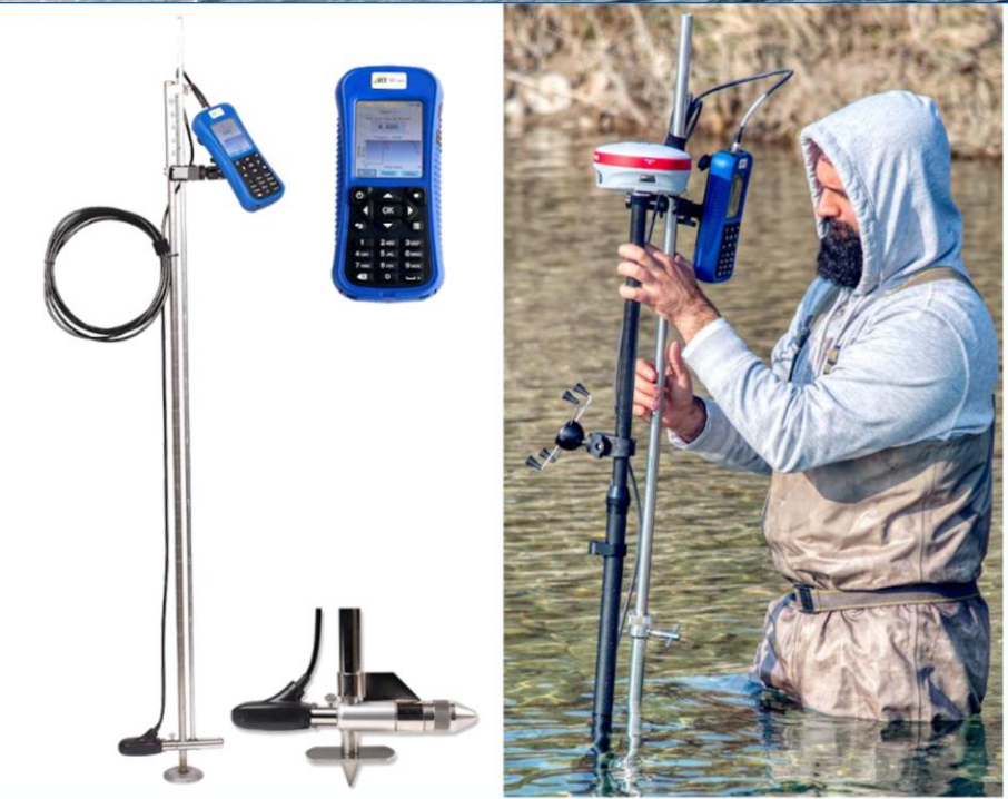
Figura 6 misuratore di profondità e velocità (Flowtracker) OTT MF Pro (a sinistra). A destra, utilizzo del Flowtracker assieme al ricevitore GNSS Stonex per la georeferenziazione delle misure di profondità e velocità.
