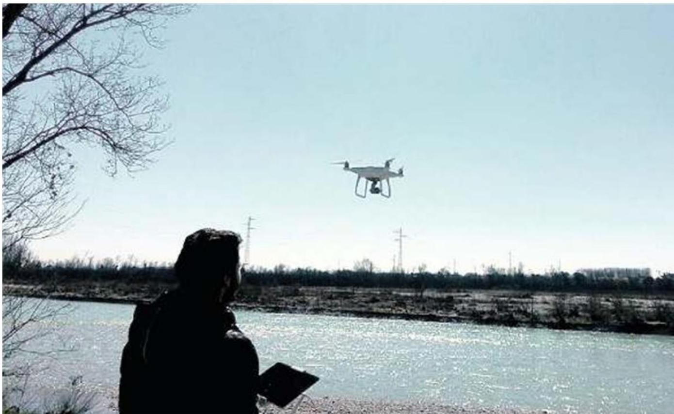
**LE RIPRESE** dello stato dei filoni d'acqua nell'alveo del Piave a Maserada ieri sono state effettuate con l'aiuto di un drone
