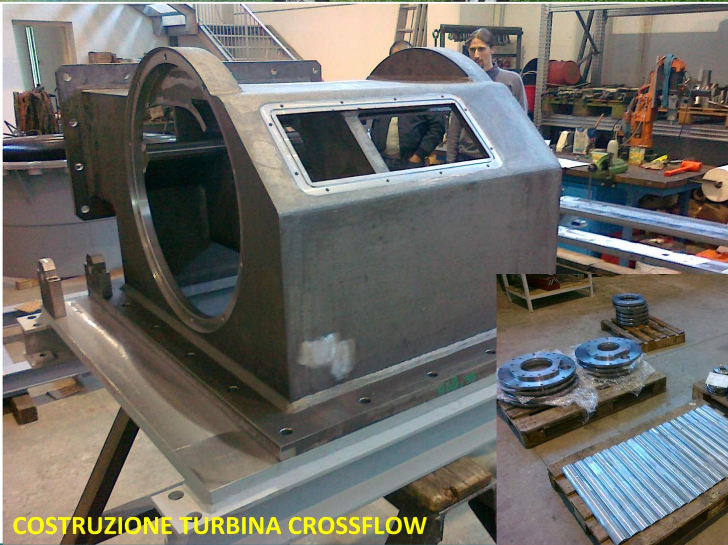
**COSTRUZIONE TURBINA CROSSFLOW**
